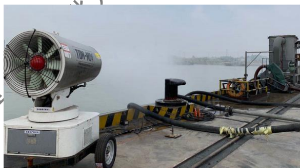
雾炮抑尘装置
