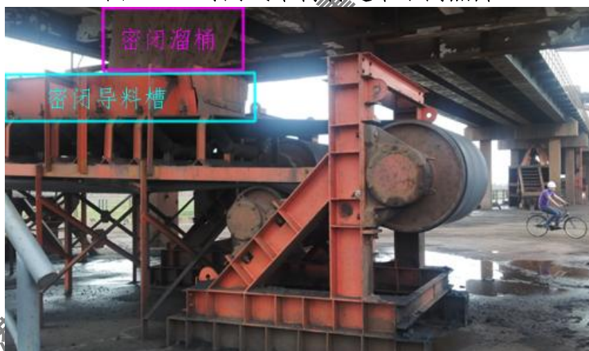
图 7.2-3 封闭式结构转运站示例照片
